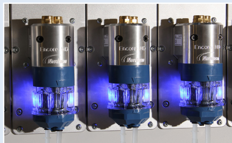
Encore HD pumps in-situ
