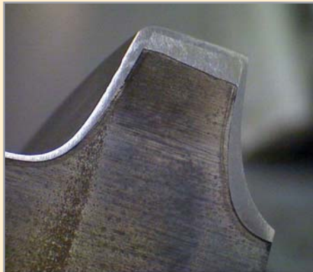
Die VERSCHLEISSFESTE MPX™-BESCHICHTUNG ist auf dem Schneckensteg zu sehen
